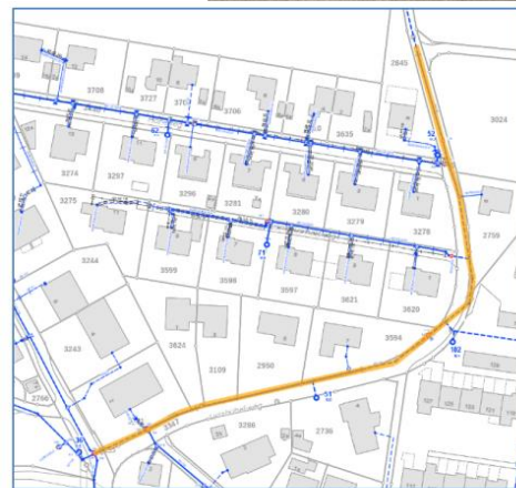
Projektperimeter mit alter Linienführung der Wasserleitung
